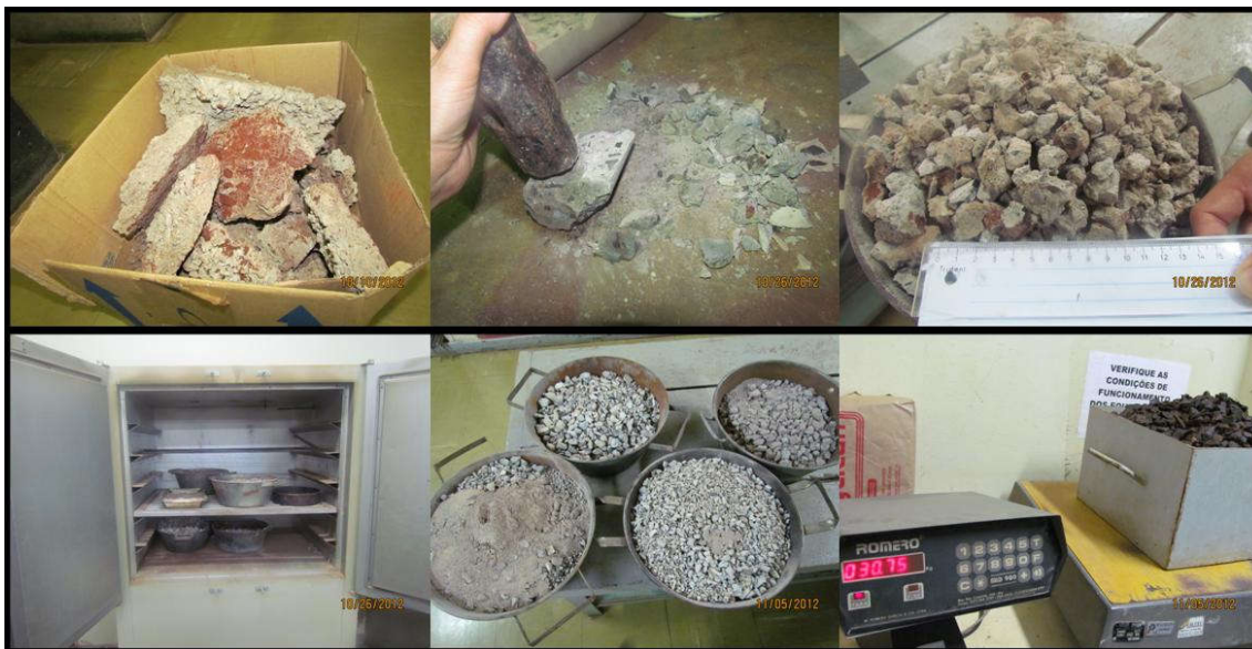
Figura 2 Preparação dos agregados para a fabricação do concreto, no Laboratório de Materiais de Construção e Mecânica de Solos, na Unidade Riachuelo, do Câmpus Jataí, em novembro de 2012.
