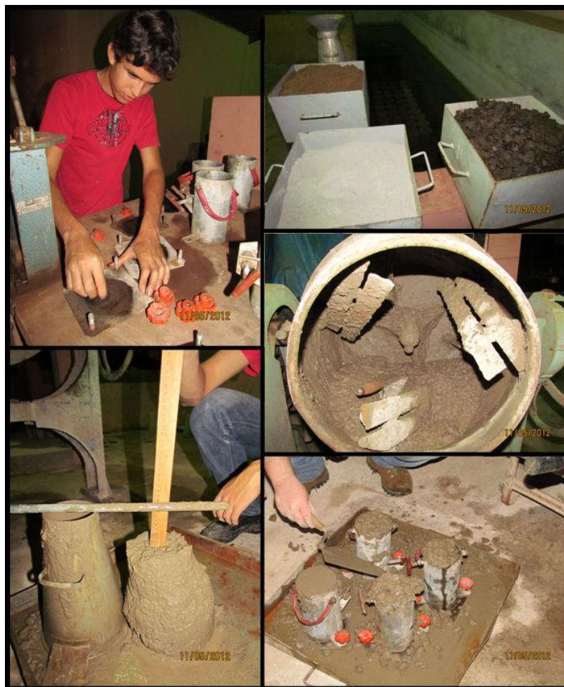
Figura 3 Processo de fabricação do concreto e realização do slum test, no Laboratório de Materiais de Construção e Mecânica de Solos, na Unidade Riachuelo, do Câmpus Jataí, em novembro de 2012.
