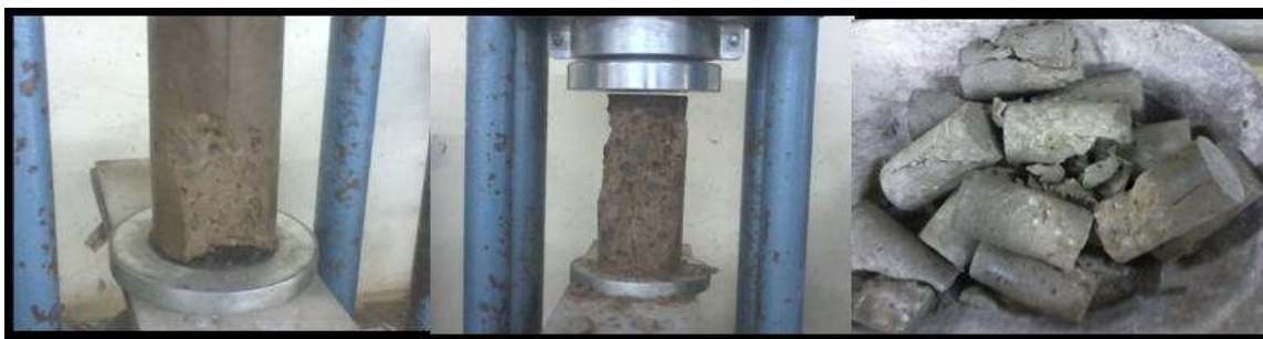
Figura 5 Teste de compressão nos corpos de prova, realizados no Laboratório de Materiais de Construção e Mecânica de Solos, na Unidade Riachuelo, do Câmpus Jataí, em novembro de 2012.
